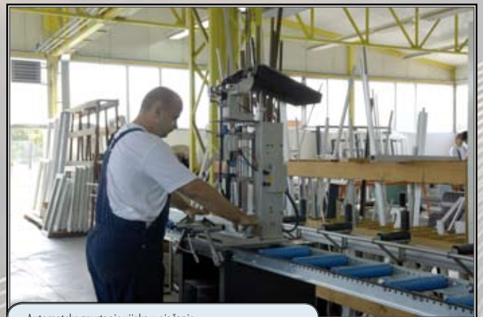
Automatsko zavrtnanje vijaka u ojačanje
